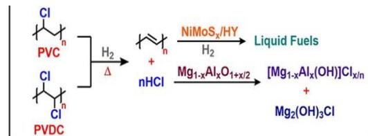
図2 廃プラ混合(含塩素)の処理
