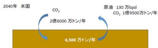
図 1 EOR による貯蔵 CO<sub>2</sub> 量
