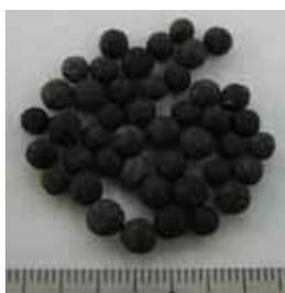
図-5 Pd/Al<sub>2</sub>O<sub>3</sub> 球状触媒<sup>3)</sup>
