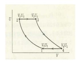
図 5 **Carnot** サイクル(空洞の **UV** ダイ ヤグラム)[1]
