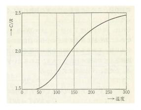
図1 H<sub>2</sub>のモル比熱の温度依存性[1]
