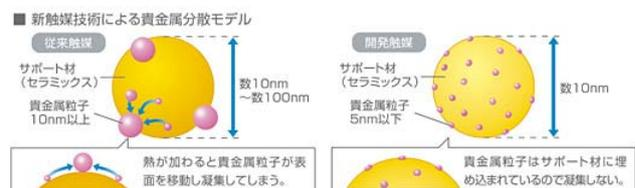
この新型触媒は、2009年よりグローバルで発売を開始する新型「マツダ・アクセラ」に採用され、触媒（床下触媒）の貴金属使用量を 0.55g/L から 0.15g/L と従来に比べ約 70%削減しながらも、国内モデルでは「平成 17 年基準排出ガス 75%低減レベル (SU-LEV)」を達成可能にしているとのことである。
