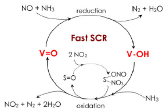
図2 “fast”SCRの反応機構 2)
